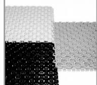
**10.** Для вернойстыковки модулей следует уложить их на основание пола и, надавливая пальцем, состыковать угловые элементы замков. Затем ударами **резиновой киянки** или молотка состыковать остальные элементы, продвигаясь в направлении от угла модуля к его краям.
